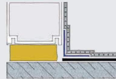
Um zu verhindern, dass ALSAN Flashing neo z. B. in Türanschlüsse oder Dämmstofflagen eindringt, sind die Übergangsbereiche mit einem Steinband zu entkoppeln.
