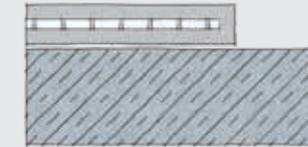
Der abzudichtende Bereich ist immer mit einem Klebeband einzugrenzen. Dies führt zu einem saubereren Arbeitsergebnis und ermöglicht die Kontrolle einer gleichmäßigen Schichtstärke. Hierbei sollte jeweils am Ende der Abdichtung ein vliesfreier Bereich von 5–10 mm eingehalten werden. (Zu weites Arbeiten über die Vliesarmierung hinaus oder eine zu hohe Schichtstärke kann dazu führen, dass sich der nicht armierte Bereich ablöst.)
