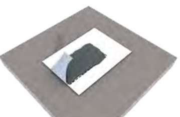
6. ALSAN Fleece 165P in die erste Lage ALSAN Flashing quadro einlegen
