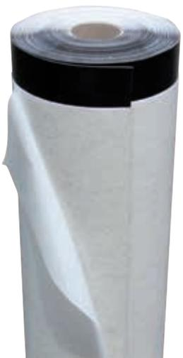
FLAGON Premio Stick ist eine **Kaltselbstklebebahn aus leistungsfähigem FPO** mit einer **hochreißfesten Glasvlieseinlage**. Sie lässt sich **auf definierten Untergründen (EPS, alukaschierte PU-Dämmung, OSB ...)** **ohne weitere Lagesicherung** einfach, schnell und sicher verkleben. Möglich macht dies eine unterseitige Vlieskaschierung mit Selbstklebeschicht.
